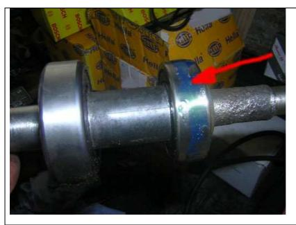
Weiter geht es mit der Welle: Lager tauschen auch am besten mit dem Abzieher herunterziehen. Das neue Lager läßt sich am besten montieren, wenn es vorher auf der Herdplatte auf ca. 80 Grad C aufgeheizt wurde. Dann fallen sie von selber drauf. Das kleinere Lager mit einem Kleber an der markierten Stelle bestreichen. (Loctide-Sekundenkleber)
