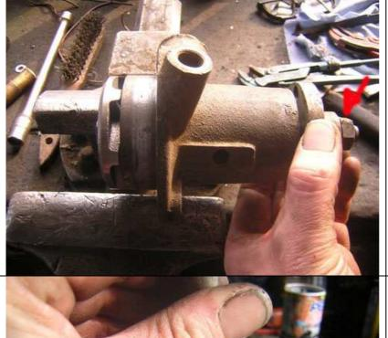
Die 2. Ausführung der Wasserpumpe ist an der vorderen Schraube zu erkennen.
