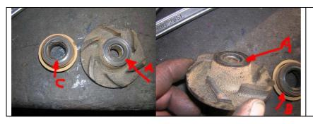
**Fehlerquellen**, die zur Undichtigkeit der Pumpe führen. Die markierten Stellen an Laufrad und Gleitring.
